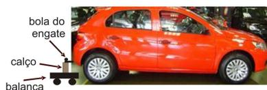
**Passo 2** - Acoplar o reboque/trailer e pesar com cuidado (peso 2). Evite que haja deslocamento do conjunto balança/calço/carro
