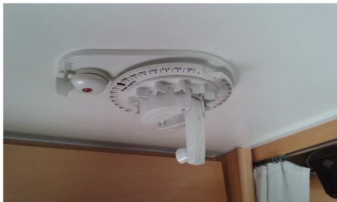
Figura 02 – acessório para elevar (alavanca) e girar (trava vermelha) a antena parabólica Winegard
