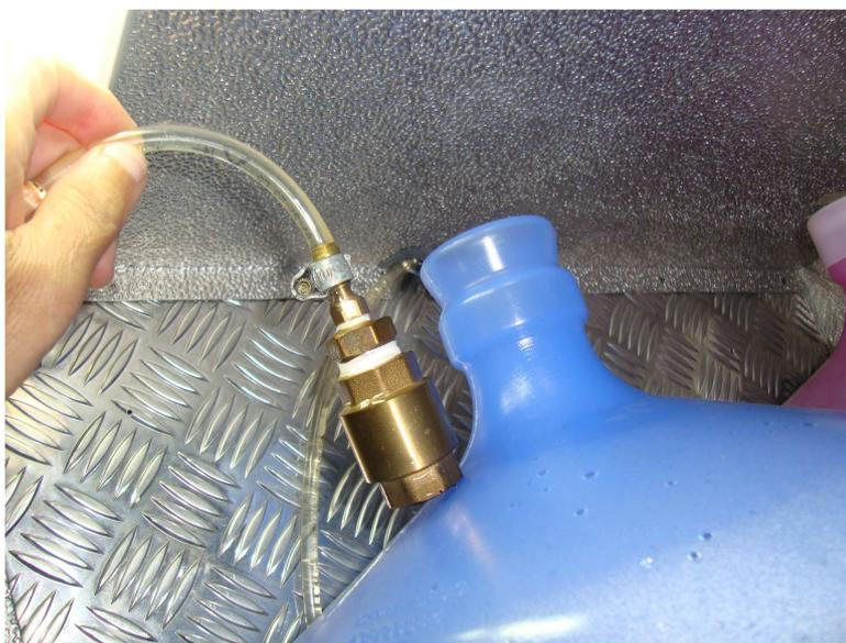
Uso de válvula de retenção em bombona de água mineral para evitar retorno da bomba
