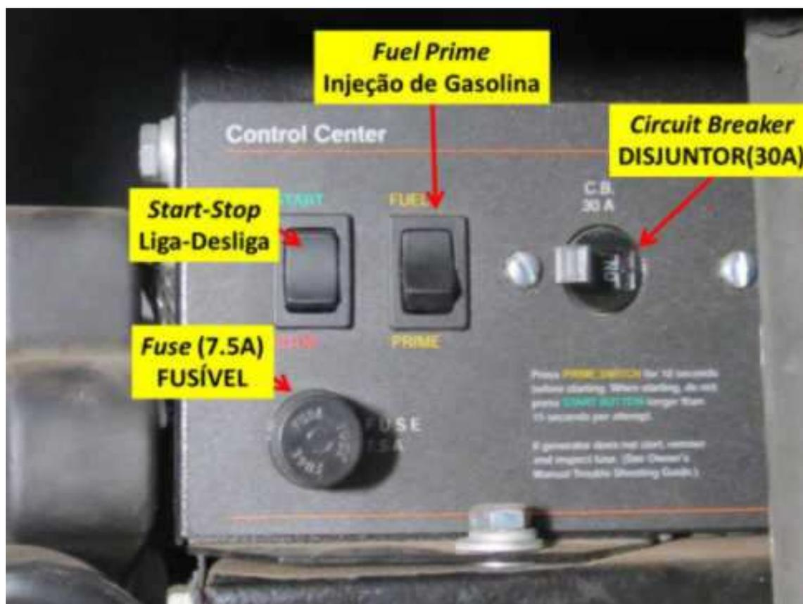
Figura 1 - Painel de comandos manuais do Gerador Generac 4.0
