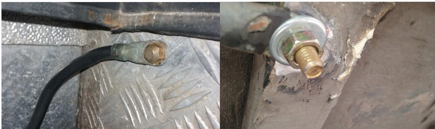
**Aterramento de polo negativo de bateria em chassi de veículo de recreação. Na figura da direita foram lixados os contatos e colocados parafuso, porca e arruela novos**
