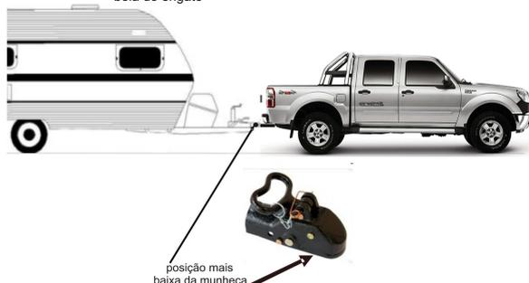
**Passo 2** - Montar o conjunto balança + calço exatamente na altura medida chão/marca na bola da munheca
