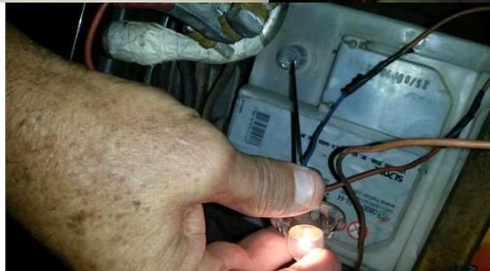
Teste (figura 1), teste conectado com lâmpada apagada (figura 2, não há fuga no sistema) e lâmpada teste acesa quando ligou-se as luzes do VR (registra corrente em fluxo para as luzes)
