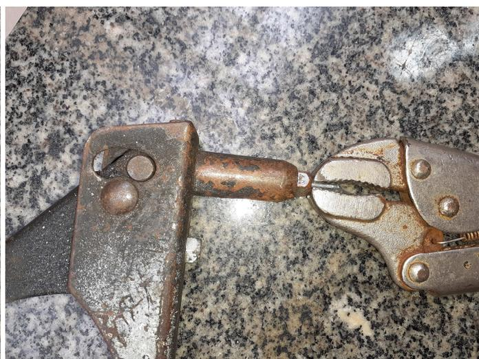
**Figura 2 – alicate de pressão remove o pino**
