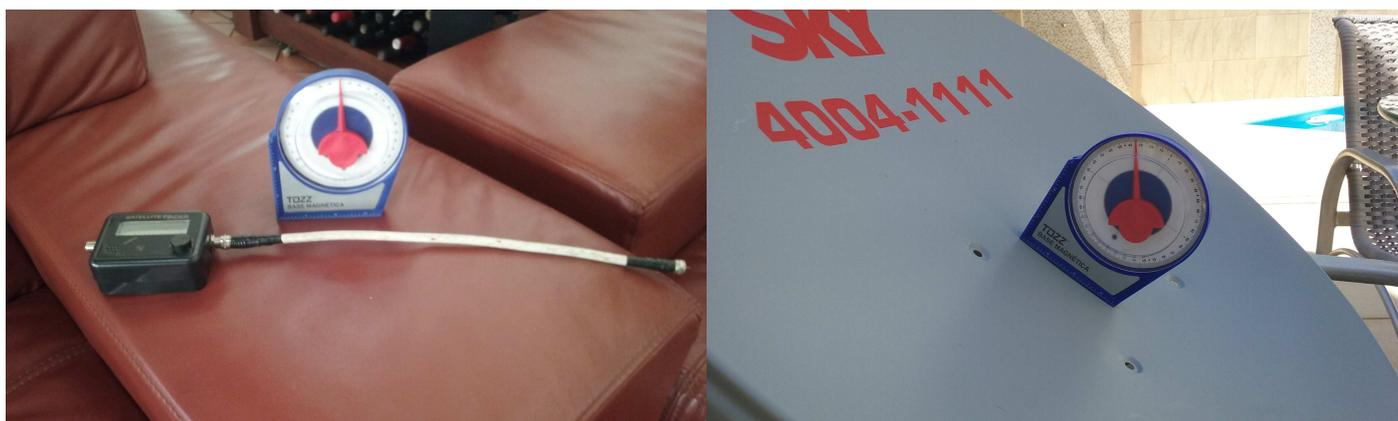
**Medidor de intensidade de sinal(*satellite finder*) e inclinômetro**
