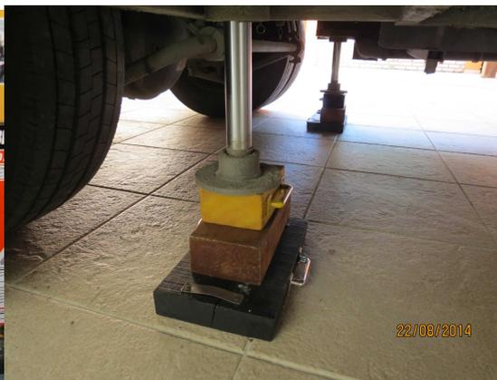
Calços para uso com sapatas. São 3 conjuntos para 3 sapatas (9 calços). Os calços pretos são os maiores em área e que preferencialmente estarão em contato com o solo. Use calços de madeiras resistentes: parajú, maçaranduba, ipê, peroba, faveiro, etc...
